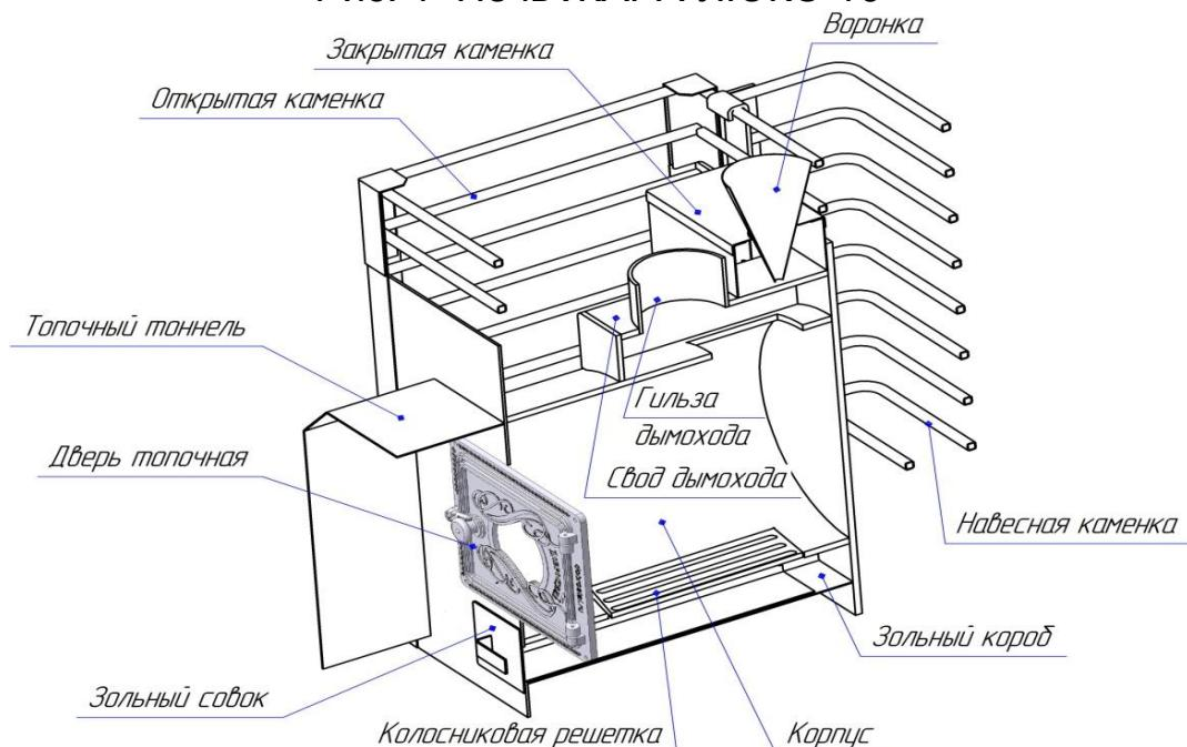
Рис. 2 Печи ЖАРА-ЛЮКС-20 и ЖАРА-ЛЮКС-30
