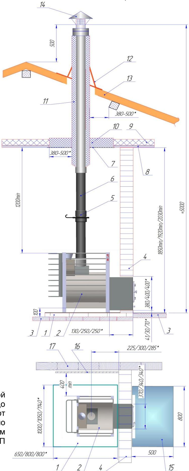
\* Расстояние от наружной поверхности дымовой трубы до возгораемых объектов зависит от типа дымохода и должно соответствовать требованиям СНиП 41-01-2003 (либо СП 7.13130.2009)
